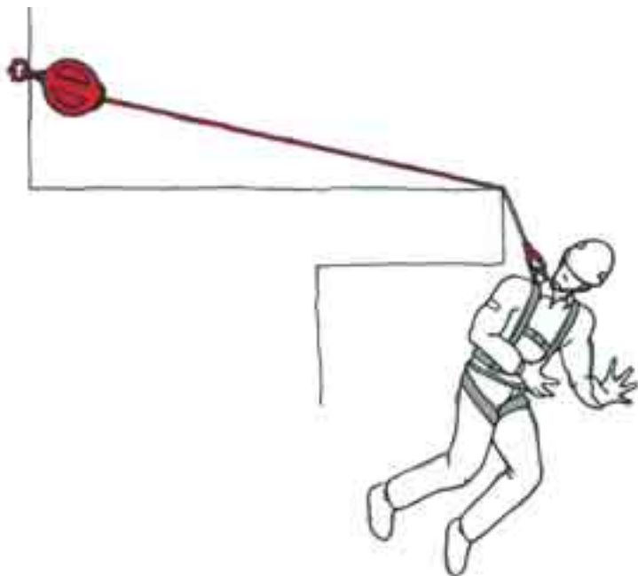
Fig. 38 - Ancoraggio disassato rispetto al punto di caduta
