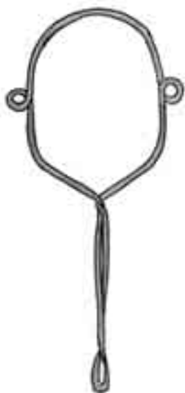
Fig. 25 - Connettore a pinza
